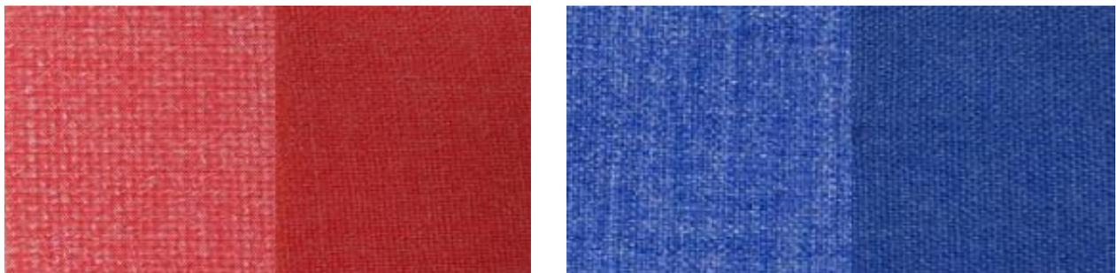
*Fotografien von PET/Wolle-Gemischen, die mit dem Farbstoff C.I. Acid Red 18 bzw. C.I. Acid Blue 80 gefärbt wurden - links jeweils unmodifiziertes PET, rechts mit Poly(vinylformamid-co-vinylamin) (PVAm) modifiziertes PET.*
