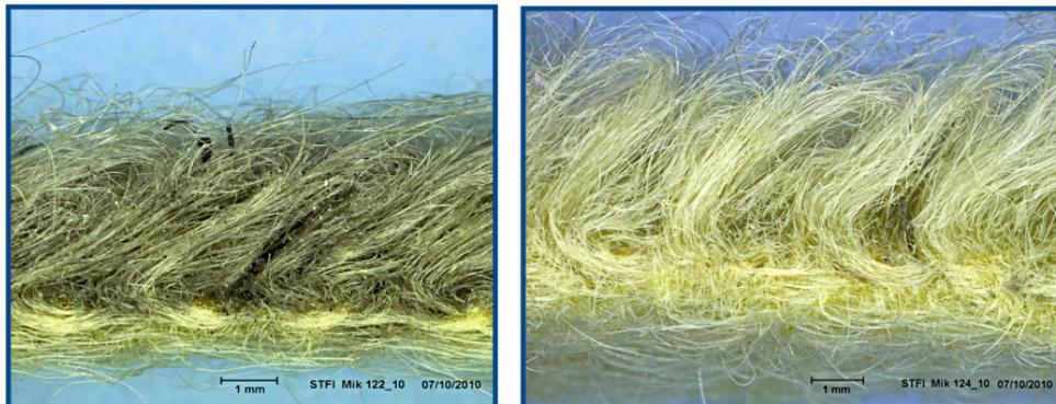
Filtermaterial HYCOKNIT® mit Staub und nach der Abreinigung (Foto: STFI)
