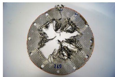
Druckstoßversuch (3 Lagen beschichtetes Vectran®-Gewebe; Berstdruck: 70,1 bar)
