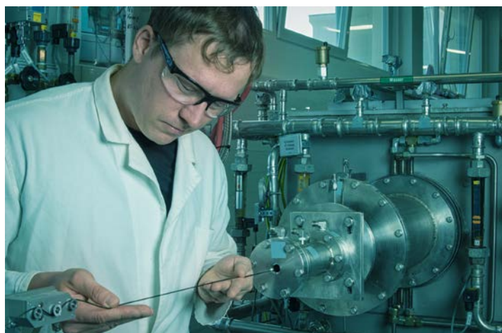
Dr. Martin Kirsten, Forschungsgruppenleiter am ITM, an der Stabilisierungs- und Carbonisierungsanlage des Instituts zur Herstellung von Kohlenstofffasern (Quelle: ITM/TU Dresden)
