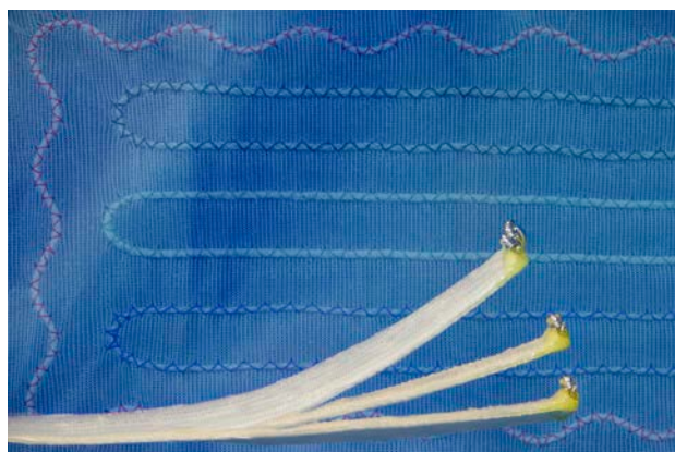
Adaptive FKV mit strukturintegrierter Aktorik (Quelle: ITM/TU Dresden)
