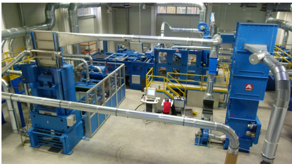
Vliesstofflinie während der Inbetriebnahme (links: Wirtvliesverfahren; rechts: Kardierverfahren (Quelle: STFI))
