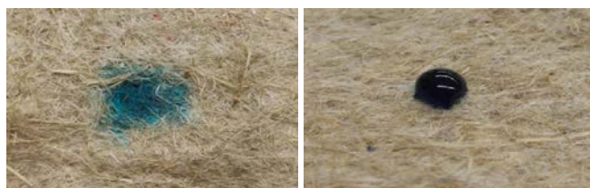
Abbildung 2: Flachsvlies naturbelassen (links) mit nachhaltiger Hydrophobausrüstung (rechts)
