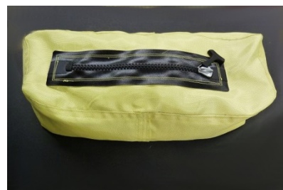
Druckstoßversuch (3 Lagen beschichtetes Vectran®-Gewebe; Berstdruck: 70,1 bar)
