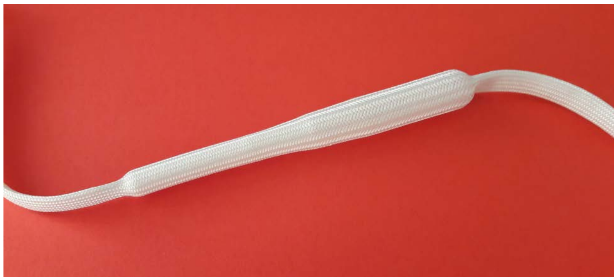
Unbeschichtete Kreuzbandstruktur bestehend aus Flüssigsilikonkautschuk-Kern und umflochten mit PET
