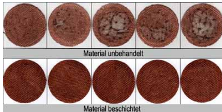
Beispiel für einen Scheuertest bei 200 bis 1000 Touren (Foto: STFI)
