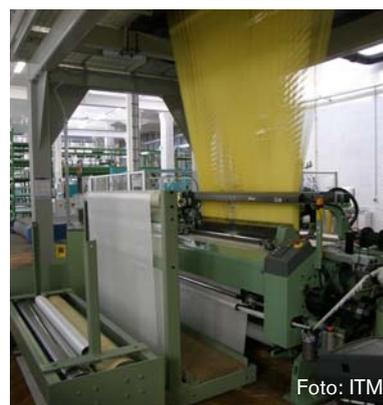
UNIVAL-Greiferwebmaschine zur Fertigung von 3D-Strukturen
