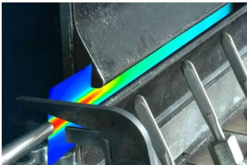
*Simulation des Strömungsfeldes im Riet einer Luftdüsenwebmaschine*
