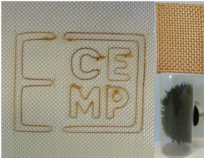
Hochfestes Polyethylen-Gewebe mit aufgesticktem, magnetisierbarem Sensorgarn (links); Gewebe mit Magnetit-Nanopartikeln und getrocknete Partikel (rechts)
