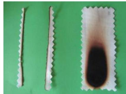
Abb. 2: Flammtests an Baumwollgeweben (links: unbehandelt, rechts: poly-phosphazenen-modifiziert)
