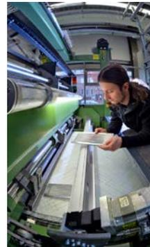
Multiaxiale Kettenwirkmaschine mit Kettfadenmanipulations-einrichtung zur Fertigung biomimetischer multifunktionale Gelege
