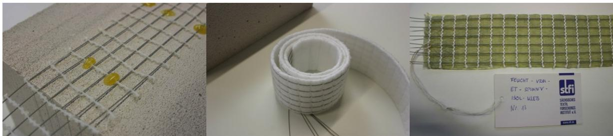
Beispiele bandartiger Sensortextilien: Gitterstruktur, Quellvliesstoff, Spinnvliesstoff
