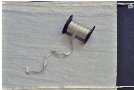
Heizmodul mit Zuleitungsband aus metallisierten Polymeren
