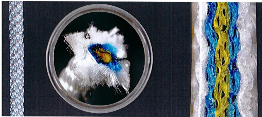
( Mehrlagenaufbau in gewebter Seilstruktur für den Aufbau geschirmter textiler Leiter )
