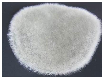
Biologisch abbaubare und druckelastische Scaffolds auf Basis von Chitosan für die Regeneration von Gelenkknorpeln (©: ITM/TU Dresden)
