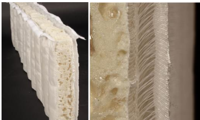
Abstandsgewebe, manuell mit PU-Schaum ausgeschäumt, und Schnitt durch die Dämm- und Hinterlüftungsebene (Fotos: FRA-UAS)
