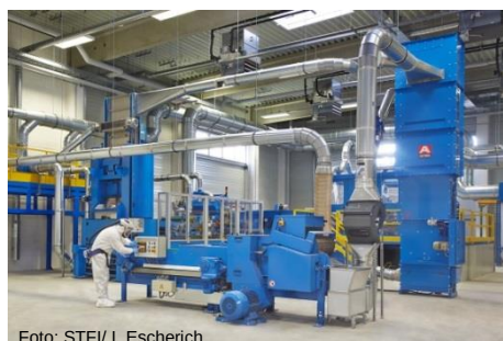
Abb.1: Semi-industrielle Pilotlinie für rCF-Vliesstoffe am STFI
