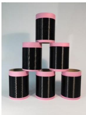
Abbildungen: Lignin-basierte Multifilament-Präkursorfasern (links), Molekulargewichtsverteilungen von unbehandeltem und modifiziertem Lignin (rechts).
